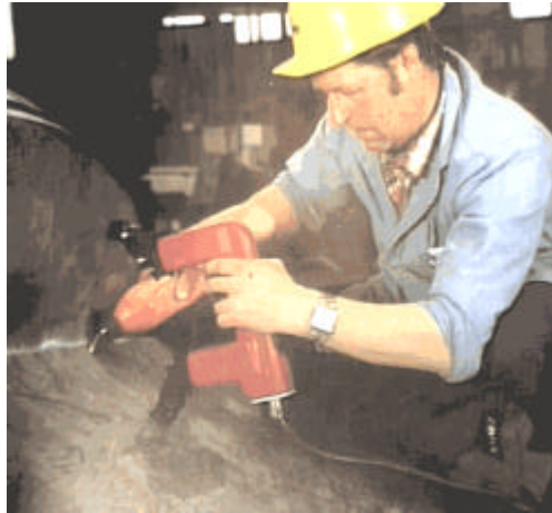
Técnica de inspeção de fundidos usando Yoke com pernas articuláveis (Foto extraída do catálogo da Tiede)
