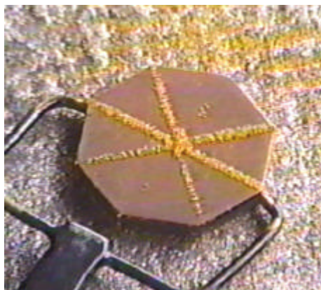
Padrão indicativo de Campo Magnético recomendado pelo Código ASME Sec.V Art.7 e ASTM - E 1444
